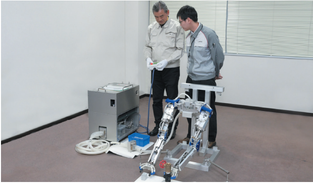
松井氏が実際にHUMALTを操作し、ブロックをつかむ動作に挑戦する。「人の入れない環境ではロボットが頼りなので、技術の進歩には期待しています。このHUMALTはリスク回避のためにあえて水圧で強い力が出せ、柔軟な動きもできるというのは驚きですね」（松井氏）
