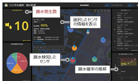
図 2: 漏水検知適用例
