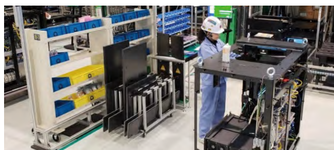
アマダ富士宮事業所に構築した組立ナビゲーションシステム
