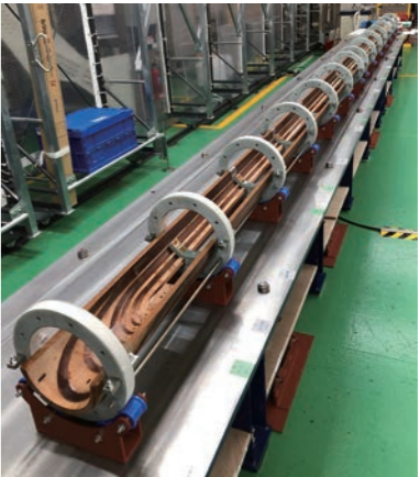
研究用加速器(CERN LHC 高輝度化アップグレード向け超伝導磁石(全長7m))
