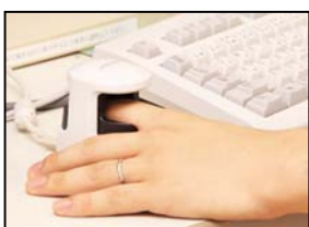
クライアントPCに接続されている指静脈認証装置
