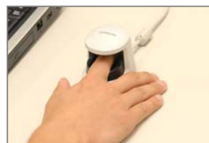
クライアントPCに接続されている指静脈認証装置
