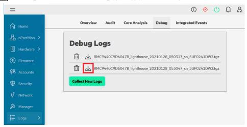
※: lighthouseログ(Debugログ)は最大で5件まで保持する事ができます。5件保持されている状態で新しく lighthouseログ(Debugログ)を採取する場合はゴミ箱アイコンを押して不要なログを削除してください。
