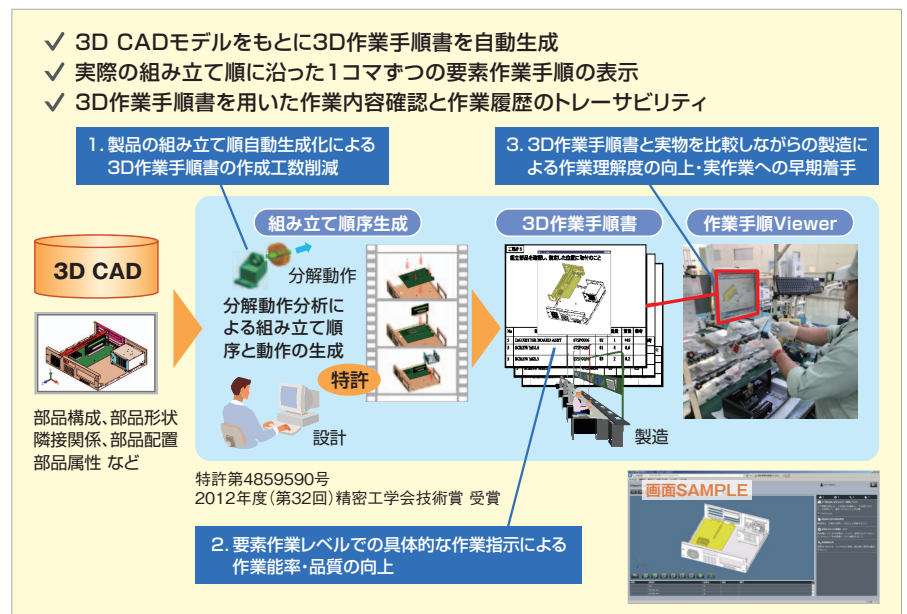
図2 組立ナビゲーションシステムの概要
