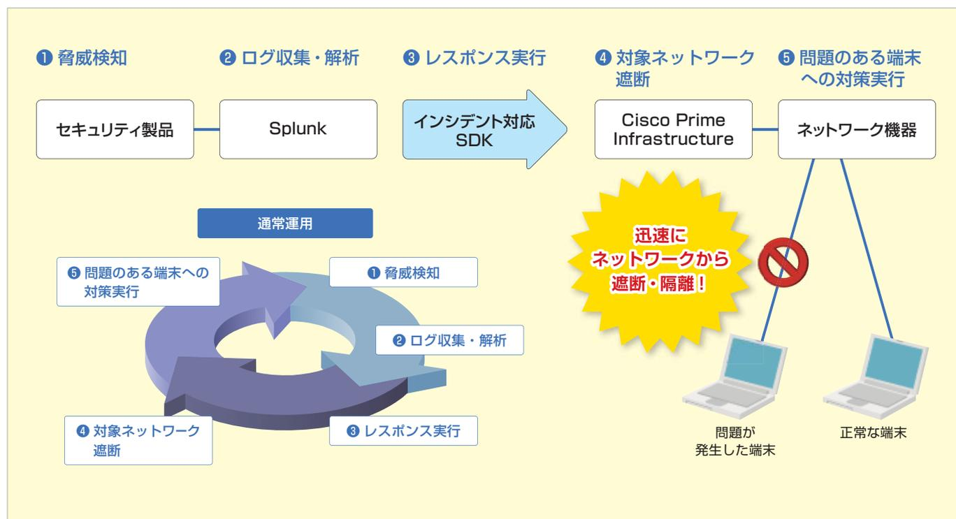
図「ネットワークセキュリティ対策自動化ソリューション」の概要
