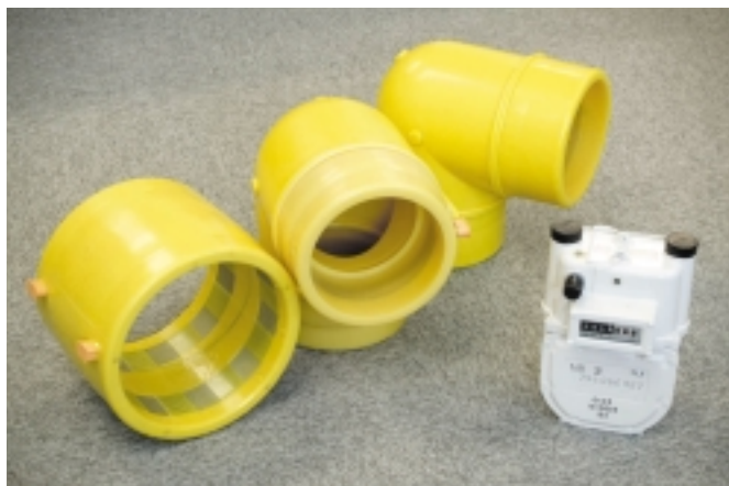
需給計画システムの対象製品である、工事材料とガスメーター。写真のポリエチレン管は、地震の際に地盤変動の影響を吸収し、損傷を最小限にいとめることができる。またマイコン内蔵ガスメーターは、多量のガス漏れやガス機器の消し忘れ、震度5強以上の地震などを感知すると自動的にガスを遮断する。
