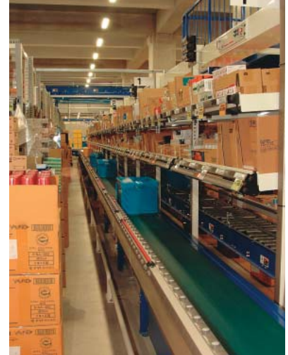
経験の少ない作業員でも簡単に正確なピッキングを行うことができる「デジタルピッキング」。対象アイテムの拡大により、トータルの出荷スピードがさらに向上した。
