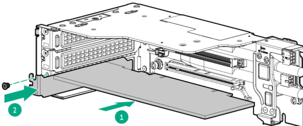
13. 必要な内部ケーブルをすべて拡張カードに接続します。
