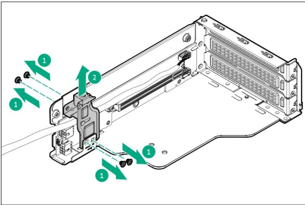
11. PCIe x16キャプティブライザーを取り外します。
