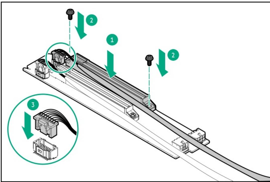
13. PCIe x16キャプティブライザーをライザーケースに取り付けます。
