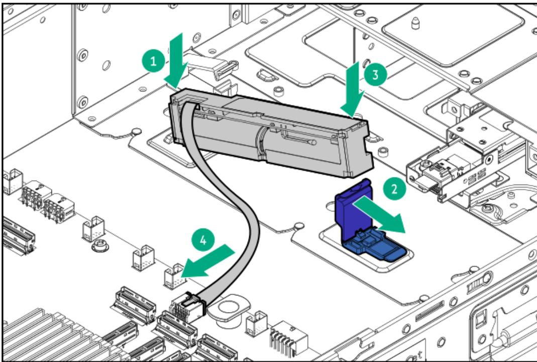
12. GPUケースとGPUを取り付けます。
