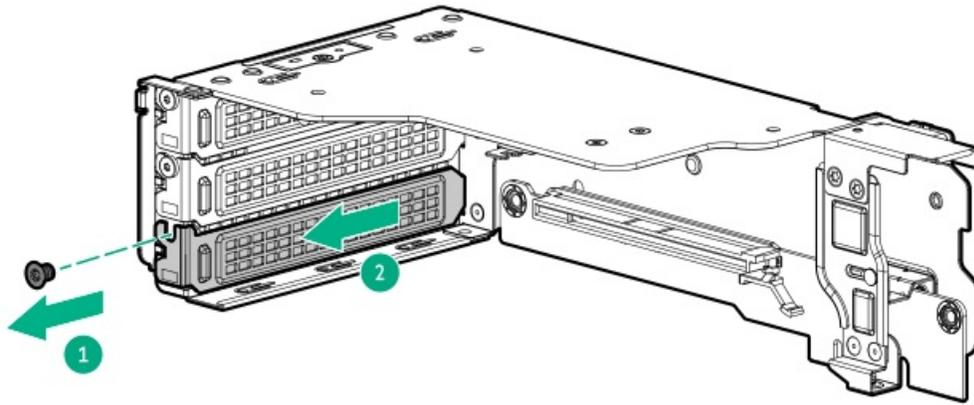
14. タイプコントローラーを取り付け、ネジを締めます。
