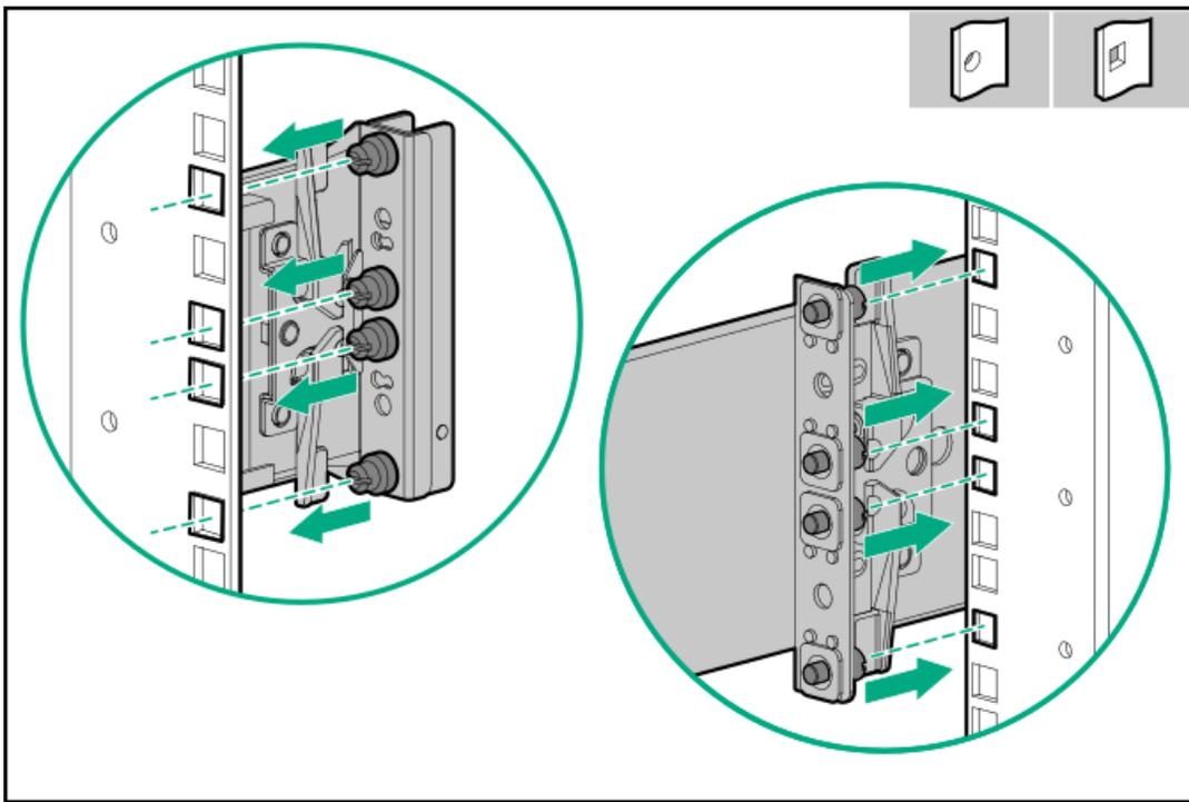
7. マウンティングレールを丸ネジ穴ラックに取り付けるには、以下の手順を実行します。
