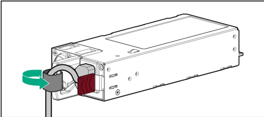
b. リリースラッチを押したまま、電源装置を取り外します。
