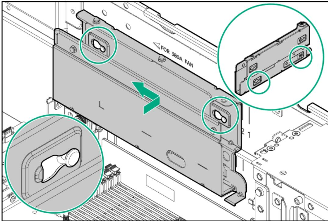
b. 左側のケーブルトラフカバーを取り付けます。
