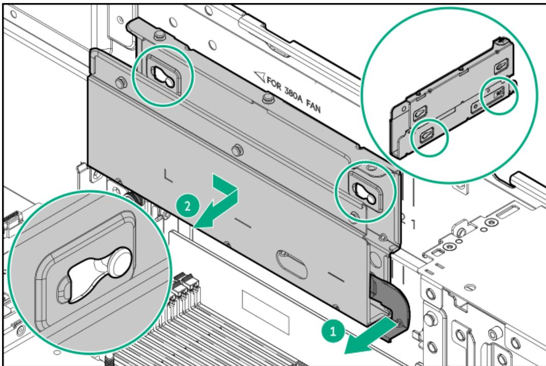
10. 左側のDIMMガードを取り外します。
