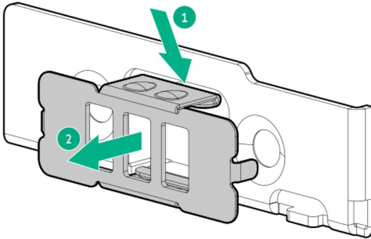
12. ixポートをタブにスライドさせて、ixポートをブラケットに固定します。
