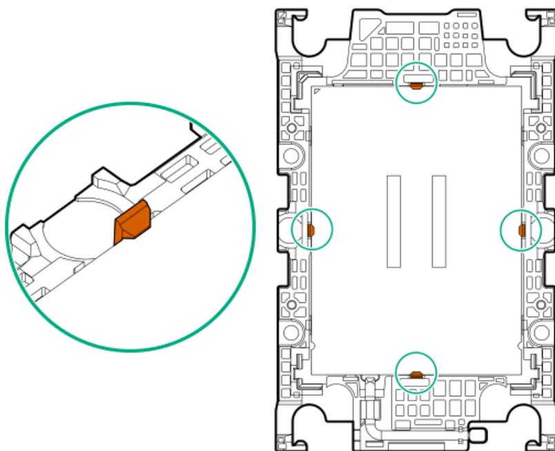
14. プロセッサソケットからダストカバーを外します。
