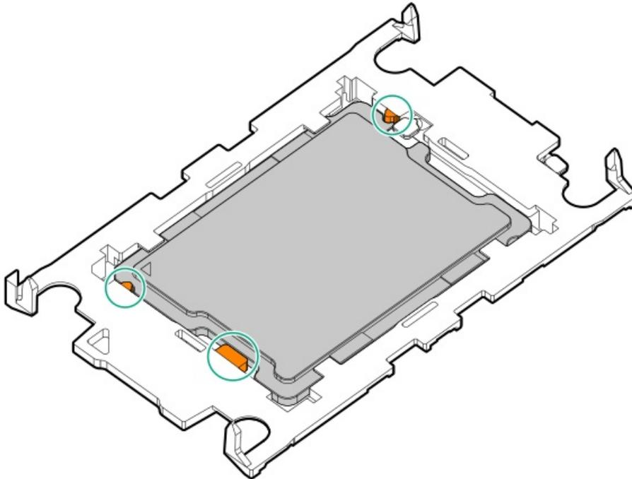
12. ヒートシンクをプロセッサキャリアに接続します。
