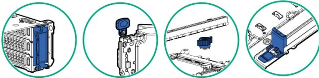
タッチポイントブルーは、コールドプラグ対応のコンポーネントを示します。これらのコンポーネントではシステムのシャットダウンが必要です。これを怠ると、システム障害やデータ損失が発生する可能性があります。コールドプラグ対応のコンポーネントは、非電気コンポーネントのタッチポイントを示す場合もあります。
