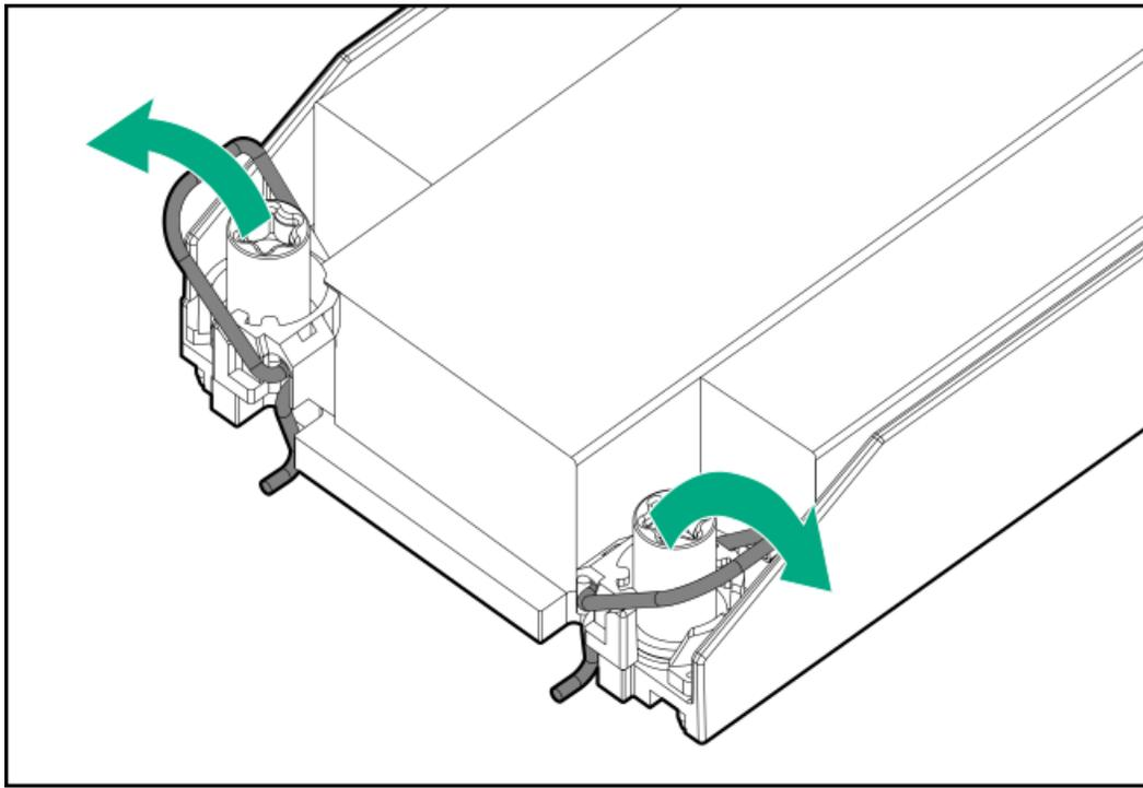
e. 対角線上にある1組のヒートシンクネジを締めて、次にもう1組のヒートシンクネジを締めます。
