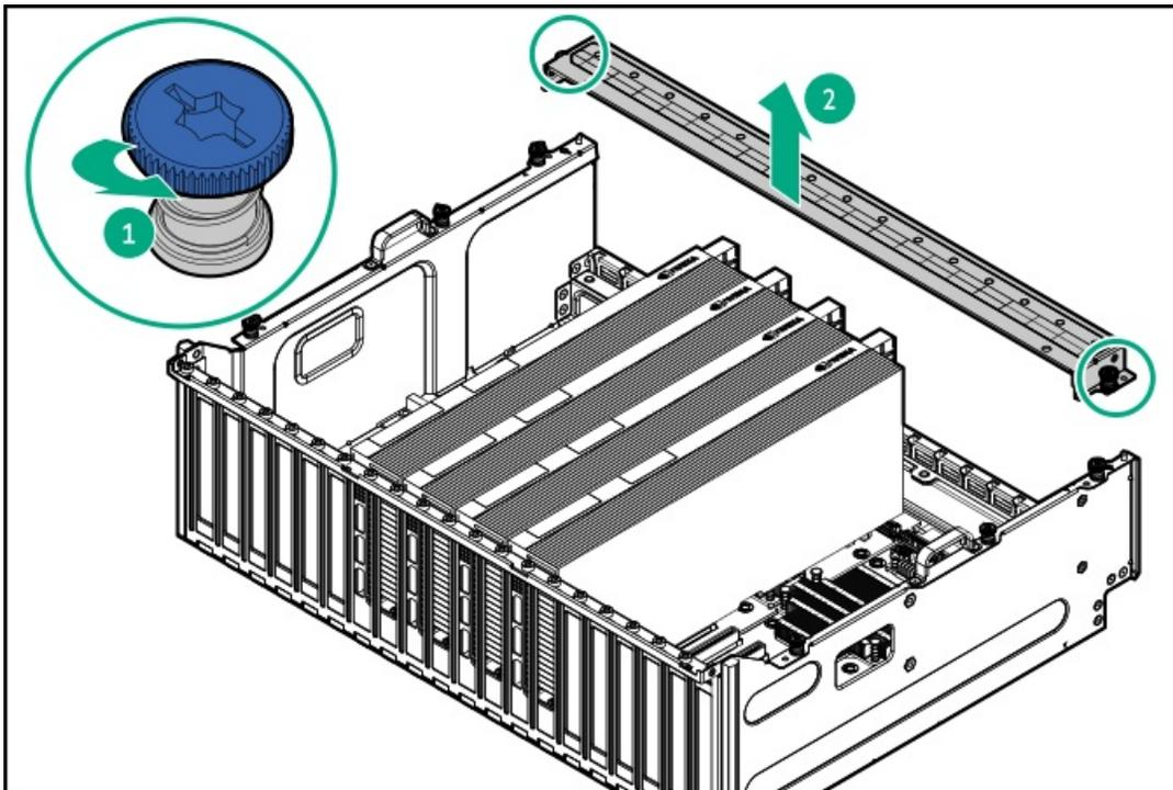
9. GPUスロットブランクを取り外します。
