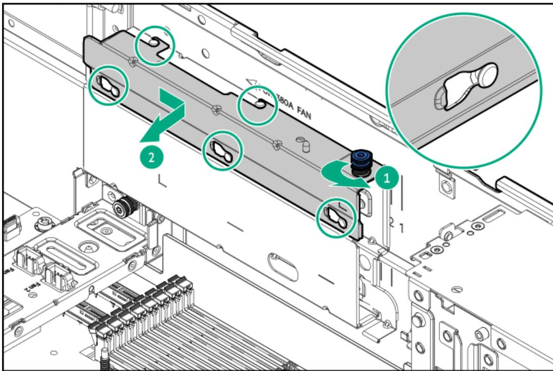
b. 左側のケーブルトラフを取り外します。
