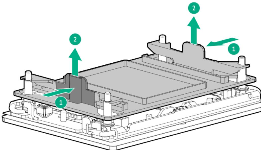
15. プロセッサヒートシンクモジュールを取り付けます。
