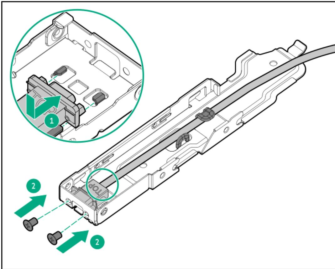
13. iXポートケーブルブラケットを電源装置ベイ1に取り付けます。
