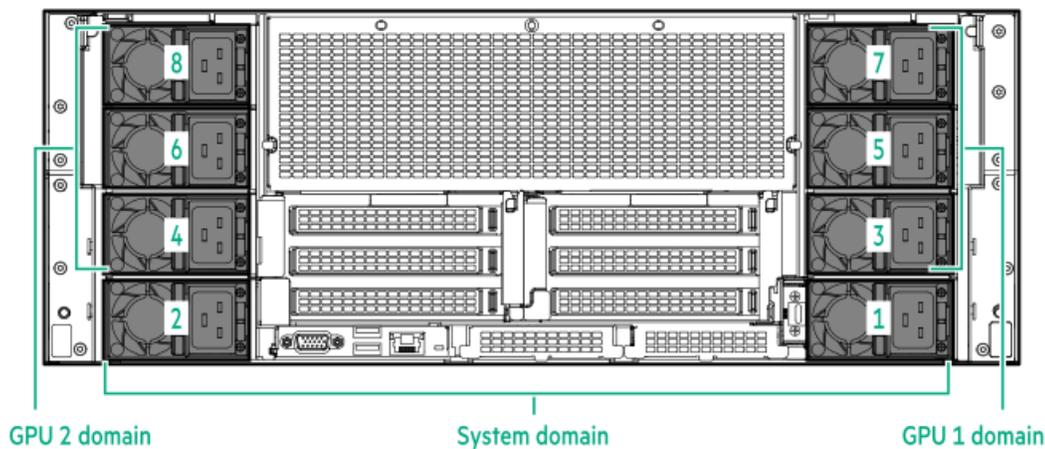
このサーバーでは、電源の冗長性をサポートするために3つの電源装置ドメインが構成されています。サーバーは、5つまたは8つの電源装置の取り付けをサポートします。
