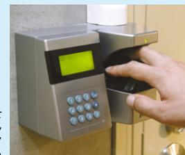
入退室管理では、ICカードは併用せず、サーバームの入り口に設置した装置で読み取った静脈パターンを認証サーバ内の情報と照合する
