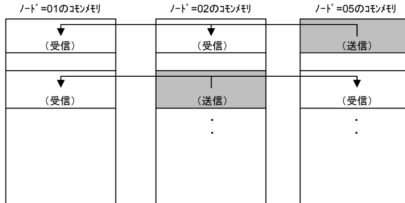
図5-15 サイクリック伝送のコモンメモリ領域例2
