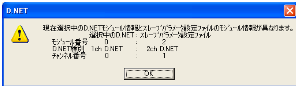
図 4-40 モジュール番号、D.NET種別、チャンネル番号がすべて異なる場合の警告メッセージダイアログボックス
