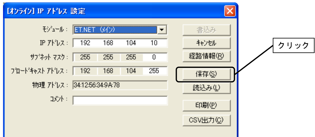
図 4-37 [[オンライン] IPアドレス設定] 画面（ 保存 ボタンをクリック）
