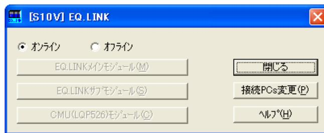
③ **接続PCs変更** ボタンをクリックしてください。[通信種類] 画面が表示されます。接続先を指定して **OK** ボタンをクリックしてください（通信種類についての詳細は、「5.2.1 接続PCs変更」を参照してください）。
