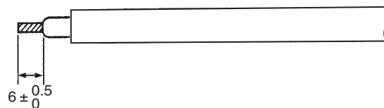
図 8-45 同軸ケーブル絶縁体剥ぎ
