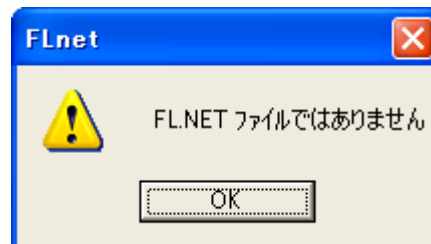
図 5-59 無効なFL.NET設定情報ファイル指定時のエラーメッセージダイアログボックス
