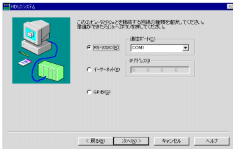
(3) チャンネル選択の [ HDLCシステム ] 画面が表示されます。「チャンネル」を選択し、**次へ** ボタンをクリックします。転送しない場合は、**キャンセル** ボタンをクリックします。
