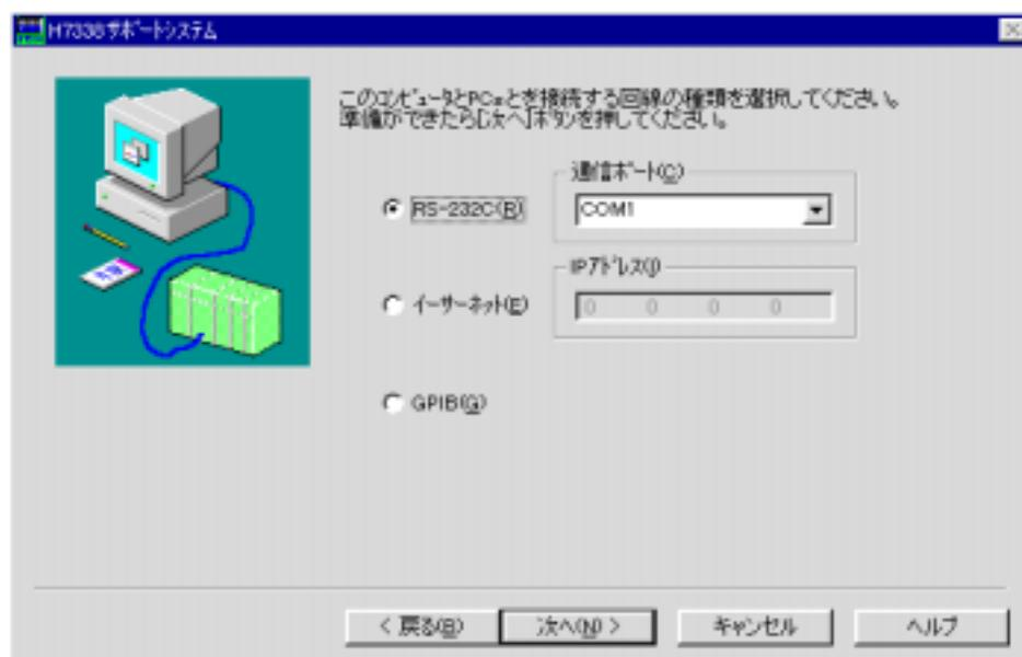
(3) チャンネル選択の [ H7338サポートシステム ] 画面が表示されます。「チャンネル」と「回線速度」を選択し、 **次へ** ボタンをクリックします。転送しない場合は、 **キャンセル** ボタンをクリックします。
