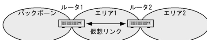
図 10-3 エリアのバックボーンへの接続
