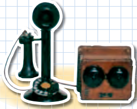
1927 (昭和2) 年 2号自動式卓上電話機 関東大震災後に使われた 最初の自動式電話機
