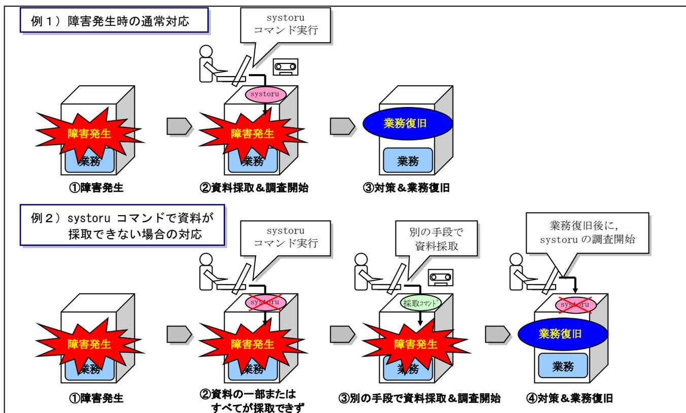
図 1-2 障害発生時の資料採取の対応
