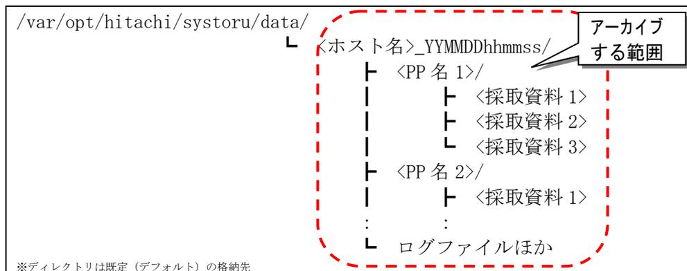
図 3-8 systoru コマンドがアーカイブするファイルおよびディレクトリ
