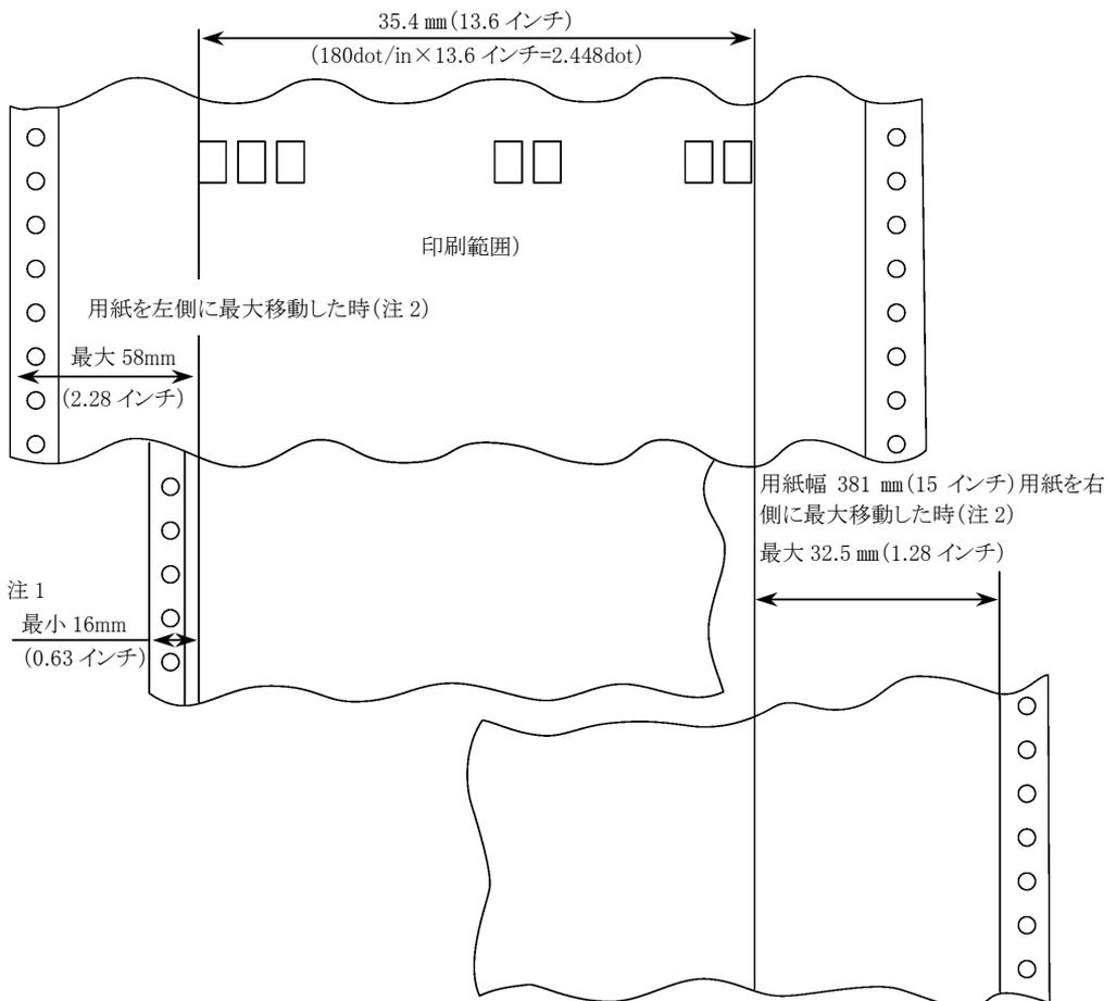
注 1) 左右用紙端から最初の印刷桁または右側用紙端から最後の印刷桁はリボンや印刷ヘッドの損傷を防止するため、最小 16 mm のマージンをとってください。(ただし、用紙端から送り孔のセンターラインは  $6.0 \pm 0.7$  mm のとき)
