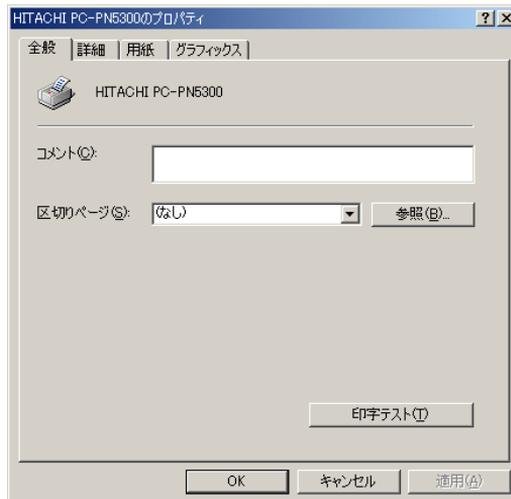
プリンタに関するコメントの入力や区切りページの指定、テストページ印刷を行います。区切りページは、印刷を行うパソコンにプリンタが直接接続されている場合のみ使用できます。
