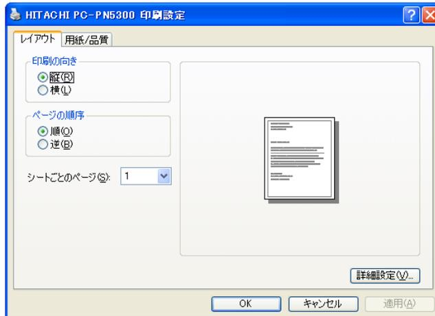
各アプリケーションでのプリンタの設定項目から表示するプリンタのプロパティです。印刷時に用紙サイズや解像度などの印刷に関する設定が行えます。
