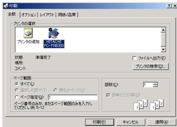
各アプリケーションでのプリンタの設定項目から表示するプリンタのプロパティです。印刷時に用紙サイズや解像度などの印刷に関する設定が行えます。
