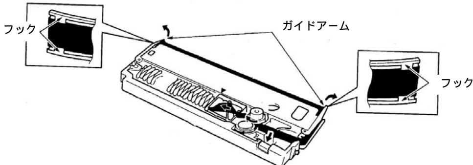
⑤ローラークローズボタンを矢印方向に押して、ローラーを閉じ、▼マークまで⑥メビウスを移動させます。⑦リボンフィードノブを時計回りに回転させ、リボンのたるみを取ります。リボンカセットカバーを閉じて、プリンタにリボンカセットをセットする準備は終了です。
