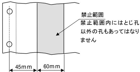
注1) とじ孔は印刷機講部に干渉し用紙破れなどが発生することがあるので1部紙には空けないでください。また、複写紙の場合最上層紙にも空けないでください。
