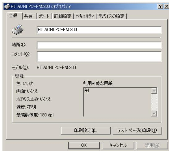
プリンタの場所の入力、コメントの入力、機能一覧の表示、印刷設定、テストページの印刷を行います。
