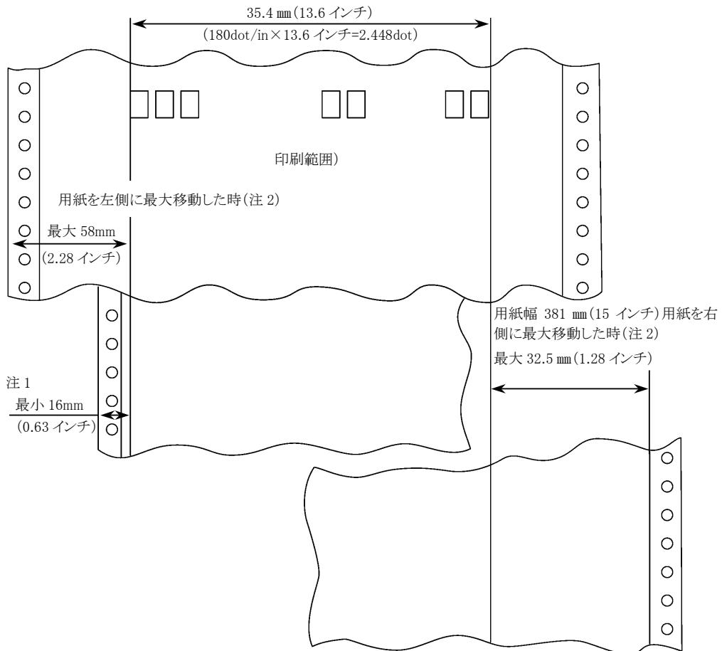
注 1) 左右用紙端から最初の印刷桁または右側用紙端から最後の印刷桁はリボンや印刷ヘッドの損傷を防止するため、最小 16 mm のマージンをとってください。(ただし、用紙端から送り孔のセンターインチは  $6.0 \pm 0.7$  mm のとき)
