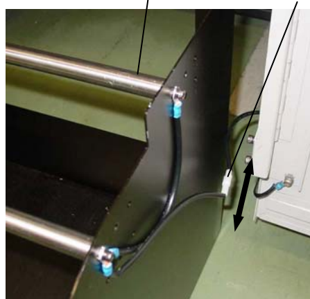
図3 重送防止ユニットの取外し
