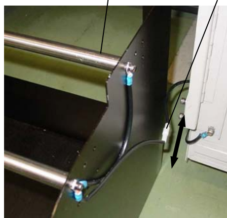
図3 重送防止ユニットの取外し
