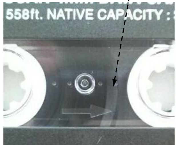
(テープのゆるみが発生した状態)
