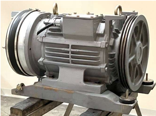
回収された永久磁石モーター巻上機の外観
