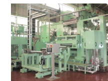
バッテリー製造用 ロールプレス設備
