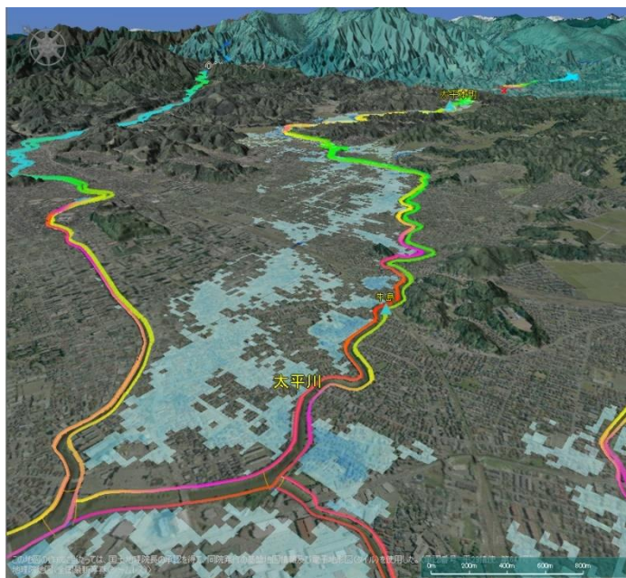
太平川の水位・洪水のシミュレーション画面
