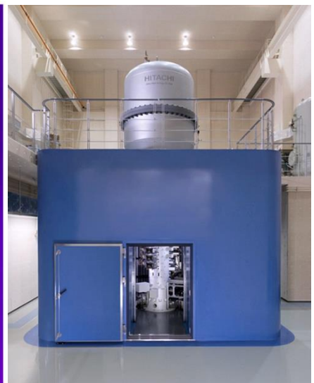
図2 観察に使用した、日立の原子分解能・ホログラフィー電子顕微鏡
