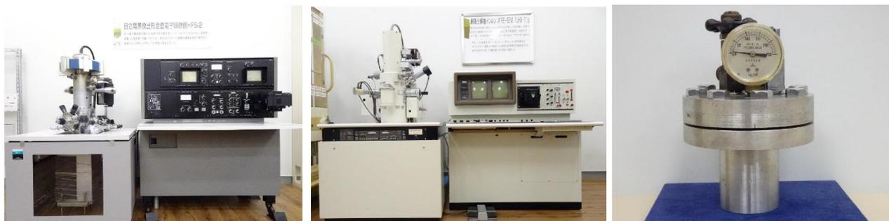
左から、「電界放出型走査電子顕微鏡 HFS-2」、「超高分解能走査型電子顕微鏡 UHS-T1 型」、
