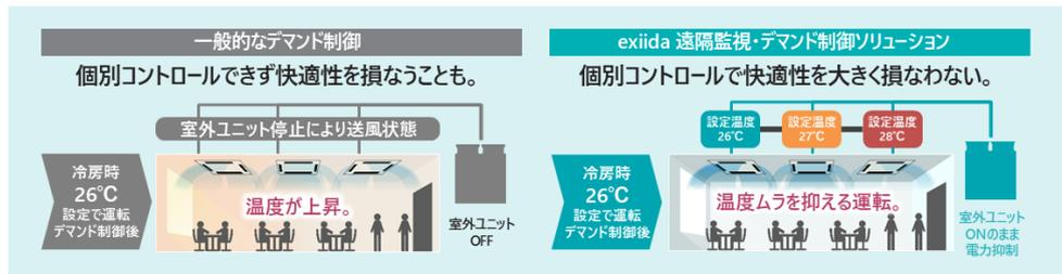
図3：一般的なデマンド制御と exiida 遠隔監視・デマンド制御ソリューションの違い
