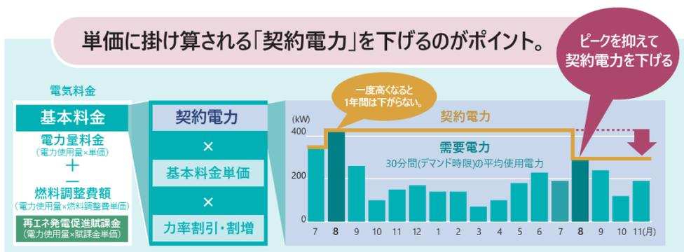
図 1：契約電力のイメージ図(高圧電力の契約が 500kW 未満の場合)
