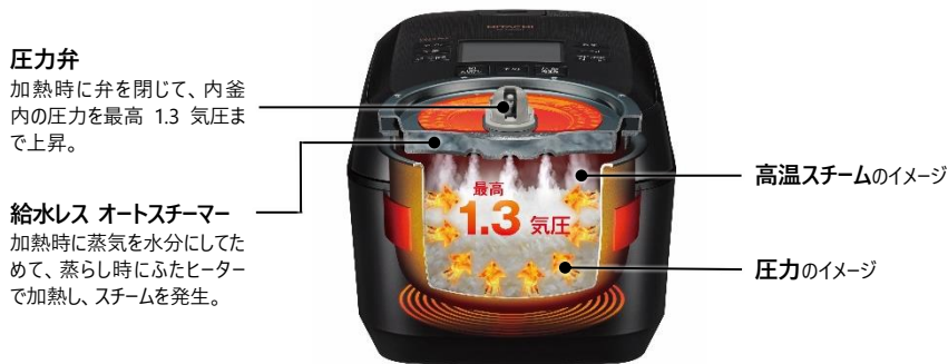
[図 4 圧騰甘み炊きの炊飯イメージ(圧カスチーム蒸らし時)]
