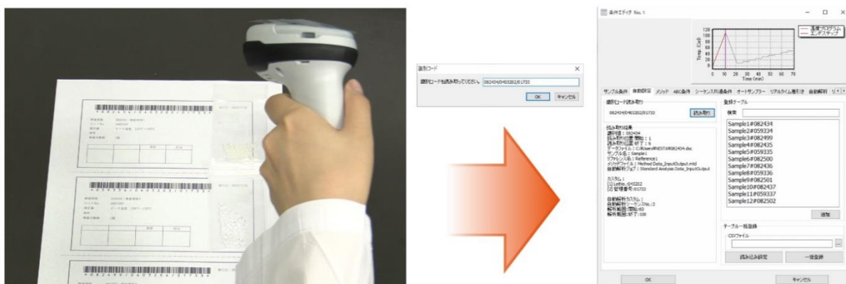
【バーコードリーダーによる測定条件の自動入力と自動入力後のソフトウェア画面】
