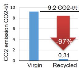
\* 冷間プレスで使用する材料は、含有化学成分を厳しく管理する必要があるため、新地金比率が高い。表は新地金（Virgin）と、再生原料からなるリサイクル材料の製造時における CO2 排出量を示しており、リサイクル材料は新地金比で CO2 排出量を 97% 削減することが可能となります。
