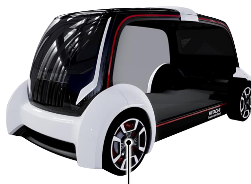
図2 「Direct Electrified Wheel」をホイール内部に 搭載した EV(モックアップ)
