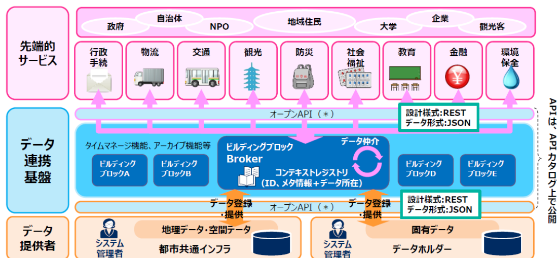
図 1 スーパーシティの構成 (出典：内閣府「スーパーシティ」構想、注 5)
