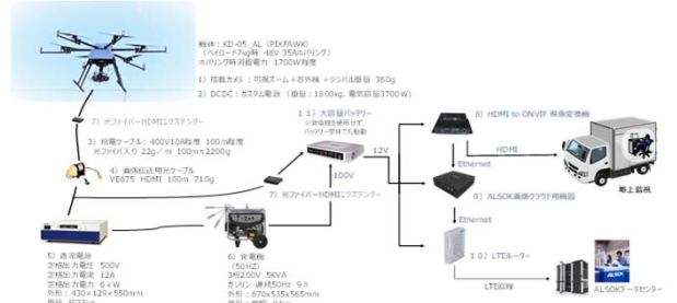
有線ドローンを用いた広域監視システム
