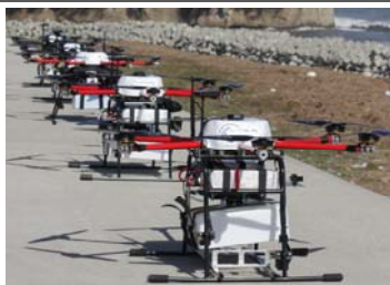
自律制御システム研究所/ACSL-PF1 (W1173×H483mm、6.2kg)
