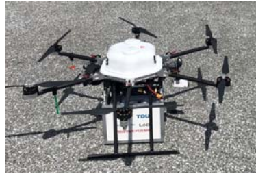
イームズロボティクス/イームズラボ製/LAB6106 (W1060×H600mm、13kg)
