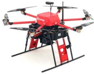
自律制御システム研究所/ACSL-PF1 (W1173×H542mm、6.4kg)
