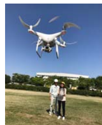
DJI/Phantom4 pro (対角寸法 350mm、1.4kg)
