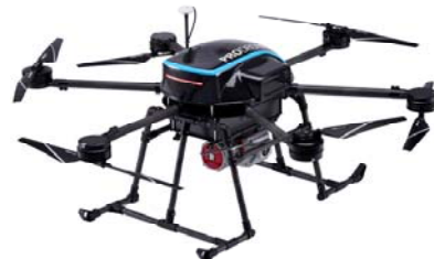
プロドローン/PD6B-type2.01 (W2000×D2000×H500mm、50kg)
