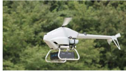
プロドローン／PDH-GS120 (W1800×D1800×H700mm、100kg)
