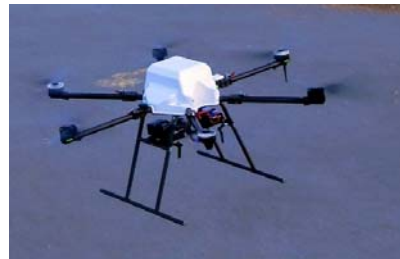
スカパーJSAT/FH1440 (W1440×H720mm、17.1kg)
