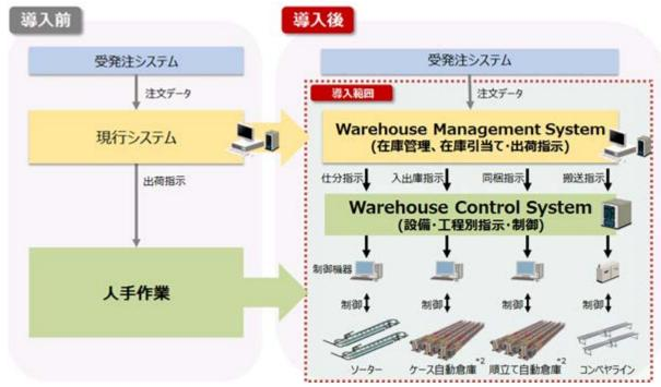
\*2 自動倉庫: 物品の入出庫をコンピュータ制御により自動的に行なう倉庫のこと。 ケース自動倉庫で仕分け工程前の物品を一時保管し、配送先別に仕分けるソーターに対して効率的に自動供給。 仕分けされた同梱可能な商品のみが順立て自動倉庫にて一時保管され、配送先ごとに纏めて出荷エリアに搬送。
