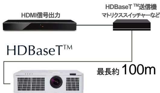
HDBaseT 入力端子との機器接続例
