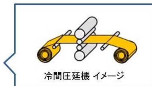
株式会社日立製作所(執行役社長兼 CEO:東原 敏昭/以下、日立)は、このたび、鉄鋼プラントの鋼板を製造する冷間圧延機\*1において、AI\*2を活用し、リアルタイムな制御を実現する技術を開発しました。今回開発した技術は、AIの中でもディープラーニング\*3を用いて独自に開発したもので、蓄積した膨大な鋼板の形状パターンや操業の実績データを機械に学習させることで、自動制御により形状(鋼板の波打ち)を補正し、鋼板の品質向上を実現するものです。本技術の導入により、熟練工の冷間圧延機の操作ノウハウをデジタル化し、制御を自動化することで、オペレーターの操作負担軽減と高品質で加工しやすい鋼板のエンドユーザーへの提供を両立することが可能となります。
