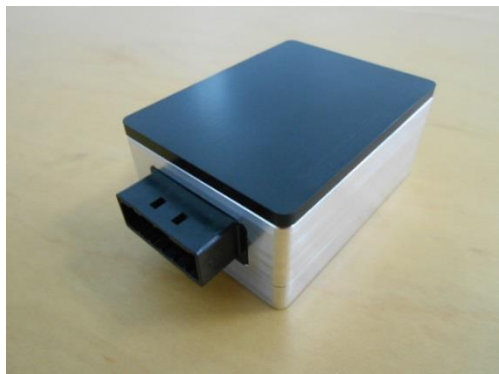
今回新たに開発した 77GHz 前方ロングレンジミリ波レーダー (奥行き:30mm、高さ:60mm、横幅:45mm)
