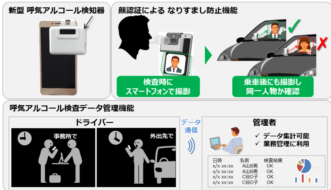
図 新型の呼気アルコール検知器とスマートフォンの連携機能概要
