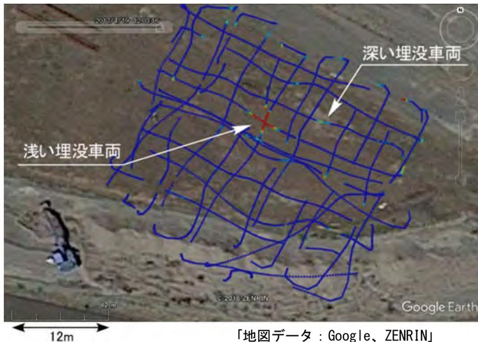
**図 6 精密ドローン航行計測による探査データ(測定周波数 60 kHz)**
