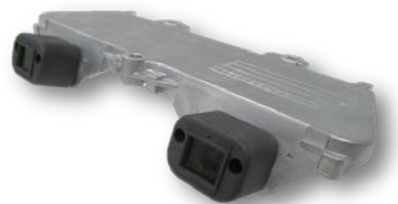
両レンズ幅を1/2に縮小したステレオカメラ
