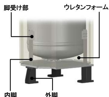
[図 2 「ウレタンク」脚部の構造 (イメージ図)]
