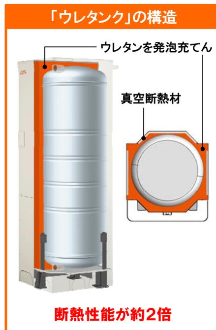
【図 1 「ウレタンク」の構造(イメージ図)】
