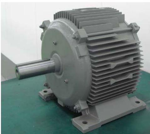
IE5 の効率レベルを達成した 11kW モーター試作機
