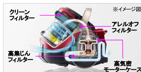
[図10 クリーン排気構造]
